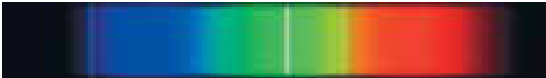
Kuva 7. Viva-Lite-lampun valon spektri.
